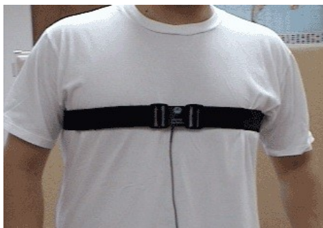
Ilustrace 16: Snímač dechové aktivity SS5LB ; převzato z: https://www.biopac.com/
