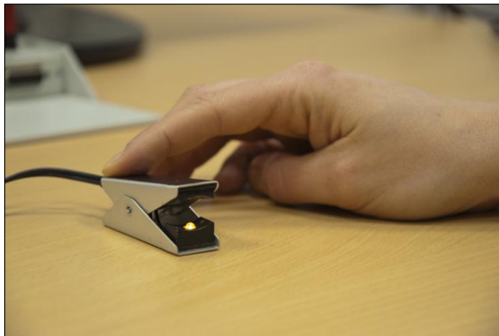
Obrázek 14: Optické čidlo systému ISES použité ve výzkumu ke snímání HR
